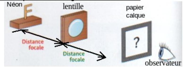
Une lentille convergente est placée entre un néon en forme de lettre F et un papier calque. Dans cette configuration, on obtient une image nette de F sur le papier calque.
